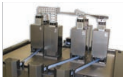
Гибкое закрепление для точного обмера деталей
