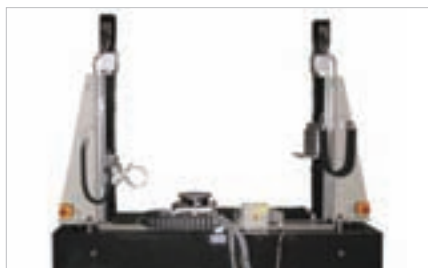
5-осевой манипулятор для рентгеновской измерительной машины
