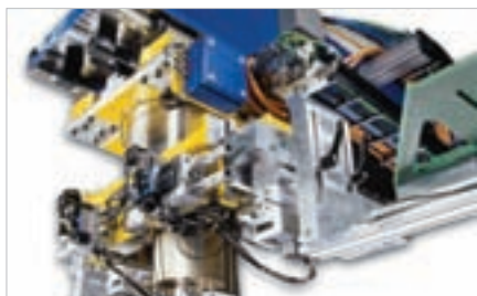
Загрузочный механизм для прецизионного вырубного пресса
