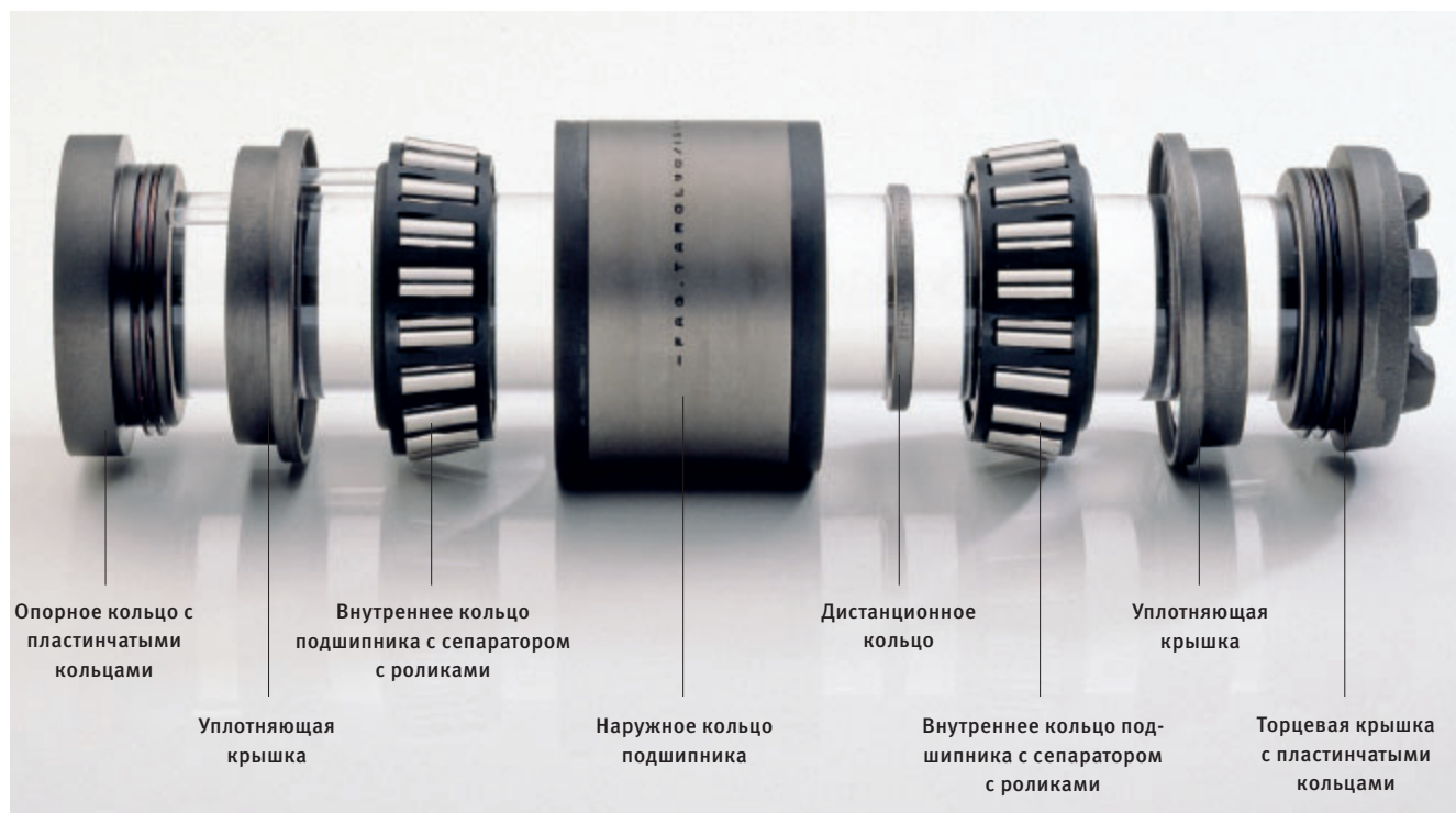
Отдельные детали узла TAROL с пластинчатыми кольцами
