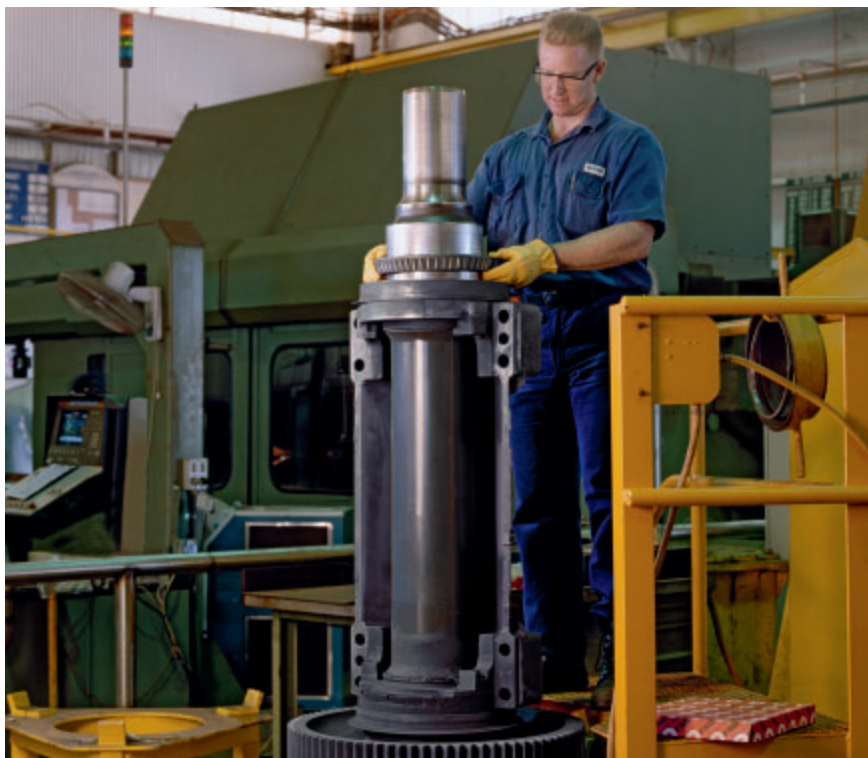
Монтаж моторноосевых подшипников
