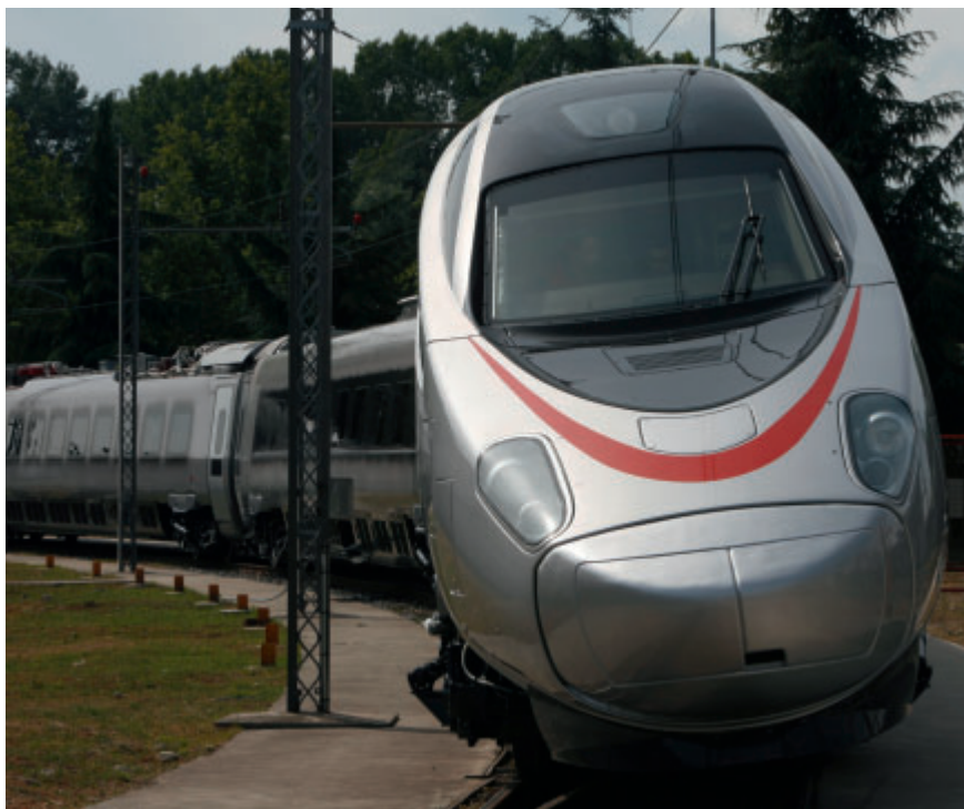
TR 600 (Trenitalia); ETR 610 (Cisalpio) с системой принудительного наклона 4-го поколения
